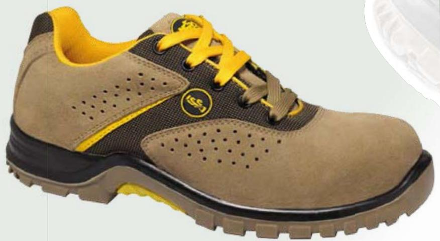
Calzatura bassa con puntale in composito e lamina tessile antiperforazione; tomaia in pelle scamosciata forata per un'eccellente traspirazione del piede. Suola in PU bidensità con inserto TPU anti torsione. Il battistrada a carrarmato ed una punta quasi priva di cuciture rendono la calzatura ideale per un utilizzo anche nel settore edile.
